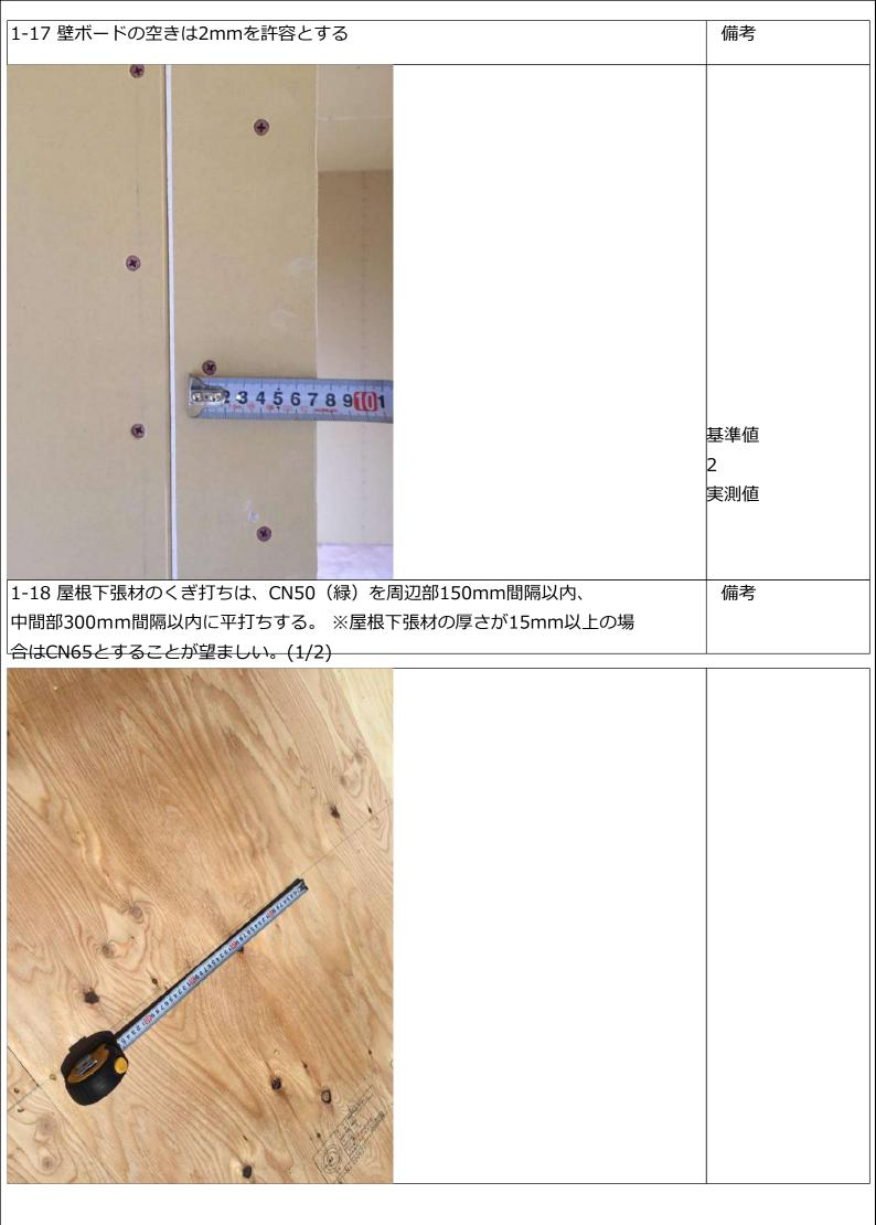
1-18 屋根下張材のくぎ打ちは、CN50(緑)を周辺部150mm間隔以内、 備考 中間部300mm間隔以内に平打ちする。 ※屋根下張材の厚さが15mm以上の場 合はCN65とすることが望ましい。(2/2) 1-21 GNF40使用 外周部100mm中間部200mm以下か 端部は10mm 備考 内側に カット thu 18 カッパ 9 カッパ 1/1 2
